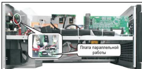
Плата параллельной работы для моделей 6 кВа и 10 кВа
