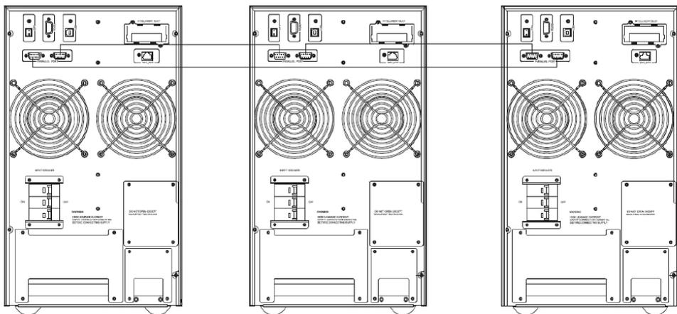
Параллельная система из трех ИБП
