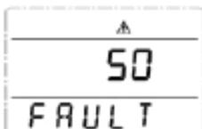
Горит красный светодиод ошибки, на LCD дисплее в области цифровой информации высвечивается код ошибки, а в области символов соответствующий значок ошибки
