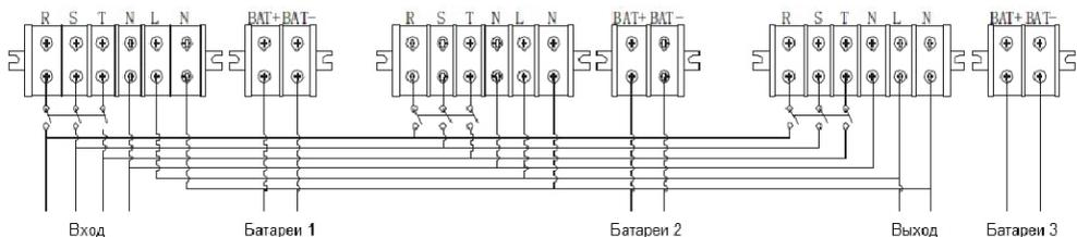
Схема подключения параллельной системы из трех ИБП
