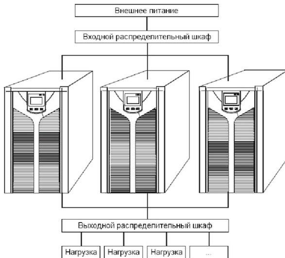
Структурная схема параллельной системы
