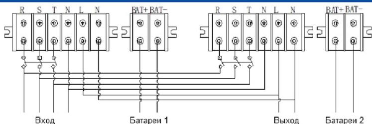
Схема подключения параллельной системы из двух ИБП
