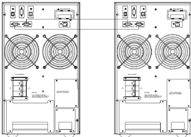
Параллельная система из двух ИБП
