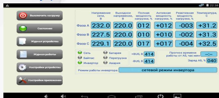
ЖК-индикация параметров и режимов работы, звуковая индикация (сигналы тревоги) при перегрузке, неисправности, высокой температуре, недопустимом отклонении параметров сети, недопустимом разряде АБ;
