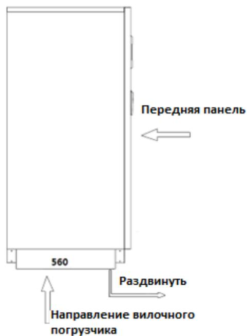
Рисунок 3-7: Перемещение ИБП 60~120 KVA (Единицы измерения: мм)
