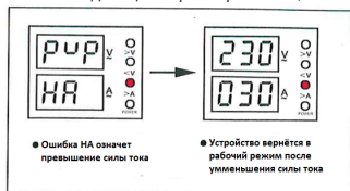
Рис. 4 – Индикация превышения силы тока
