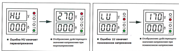
Рис. 3 – Индикация перенапряжения / пониженного напряжения
